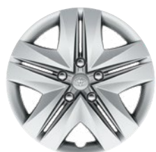
16" ocelová kola s celoplošnými kryty, pneumatiky 205/55 R16 Pro výbavu Active
